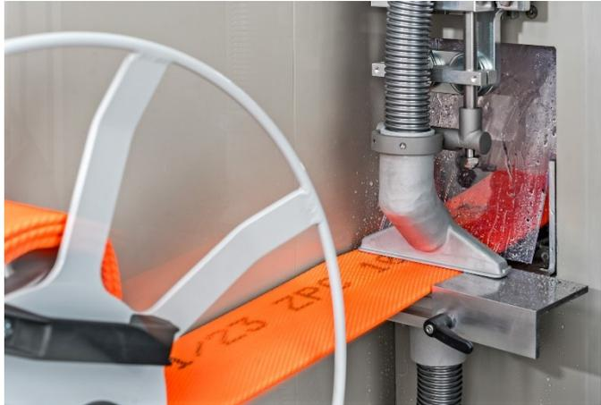
Direkt während der Reinigung erfolgt vollautomatisch die Trocknung der Schläuche mittels effizienter Vakuumtechnik. Über Düsen wird das Waschwasser beidseitig von der Oberfläche des Schlauches abgesaugt. Durch diesen Prozess wird neben der Trocknung eine zusätzliche Reinigung der Schläuche erreicht. Das abgesaugte Wasser wird in einem, in der Anlage integrierten Behälter aufgefangen und vollautomatisch abgepumpt.
